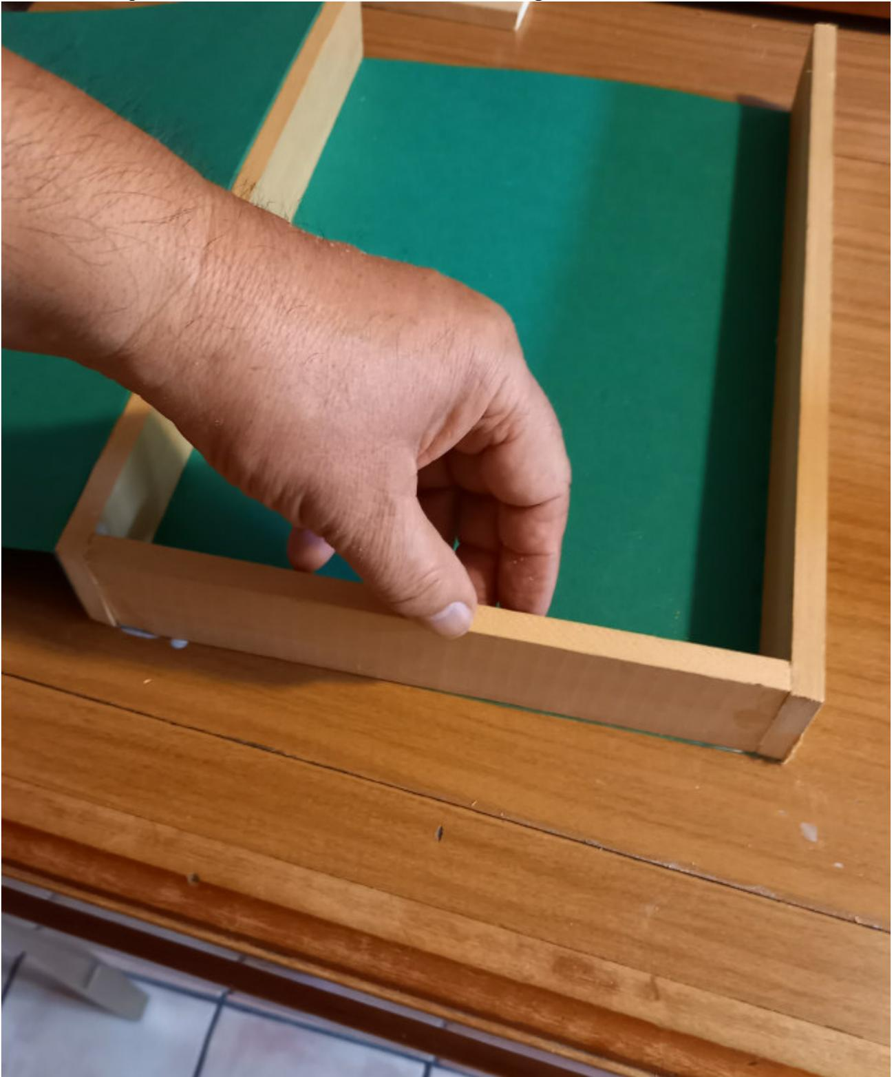
Completate la cornice con una seconda lista tagliata a misura e incollata a pressione fino al “tiraggio” della colla.
